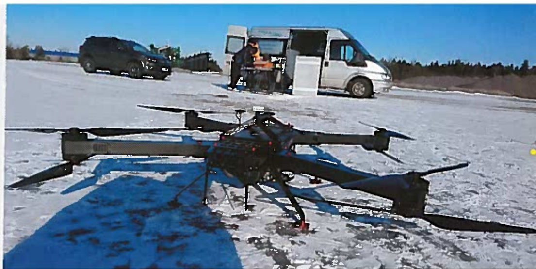
RiCopter varustettuna VUX-SYS skannerijärjestelmällä ja kahdella Sony Alpha 6000 kameralla valmiina kartoituslennolle Turun Saramäessä Turussa Timo Toivonen
