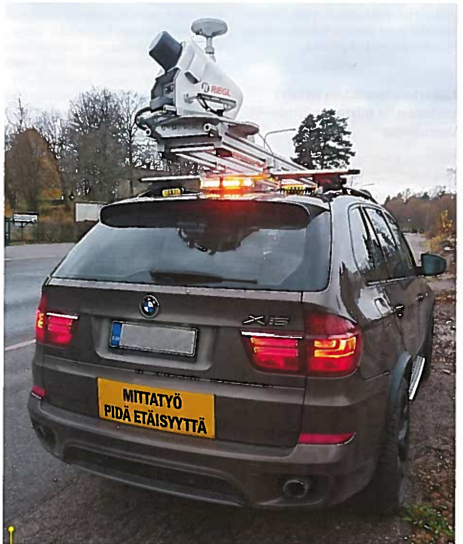
Mobiililaserkeilain VMQ lähes käyttövalmiina tehtävään Heikki Häkklä
